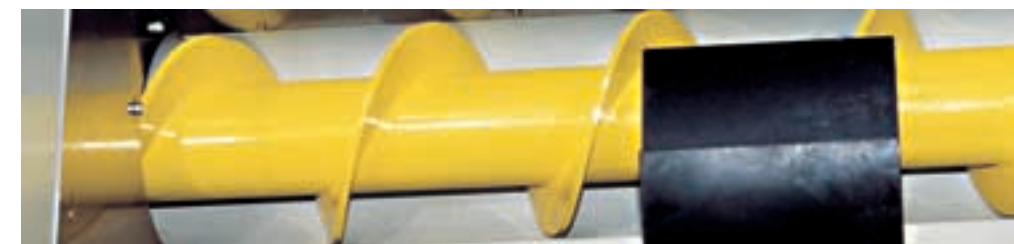
Kein Problem mit dicken Ballen, verdichtete Sackinhalte können als Ganzes in die Maschine gegeben werden. Ein problemloses Sammeln des Dämmstoffes gewährleisten die Schnecke und der Zuführer.
