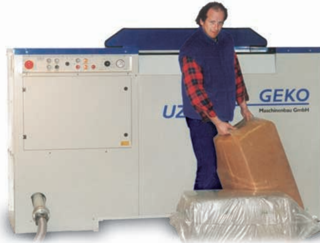
Kein Problem mit dicken Ballen, verdichtete Sackinhalte können als Ganzes in die Maschine gegeben werden. Ein problemloses Sammeln des Dämmstoffes gewährleisten die Schnecke und der Zuführer.
